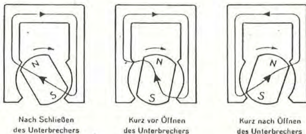
Abb. 394 Kraftflußwechsel im Anker eines Magnetzünders mit umlaufendem Magnet
